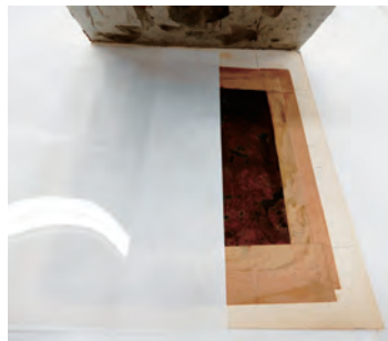
②ダゲレオハウジングの内部に中性紙とマイラーの挿入
