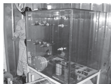
写真2. 1 m 3 ボックスに庫外投薬装置よりガス化した燻蒸剤を導入 3)
